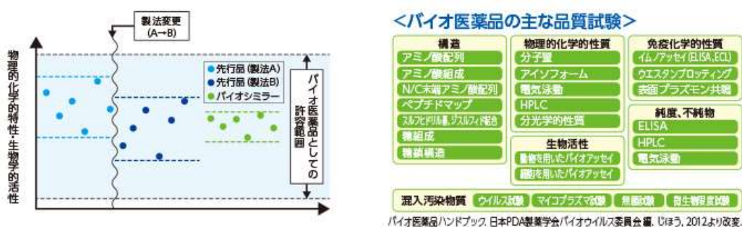
図 15 バイオ医薬品の主な品質試験とその方法
